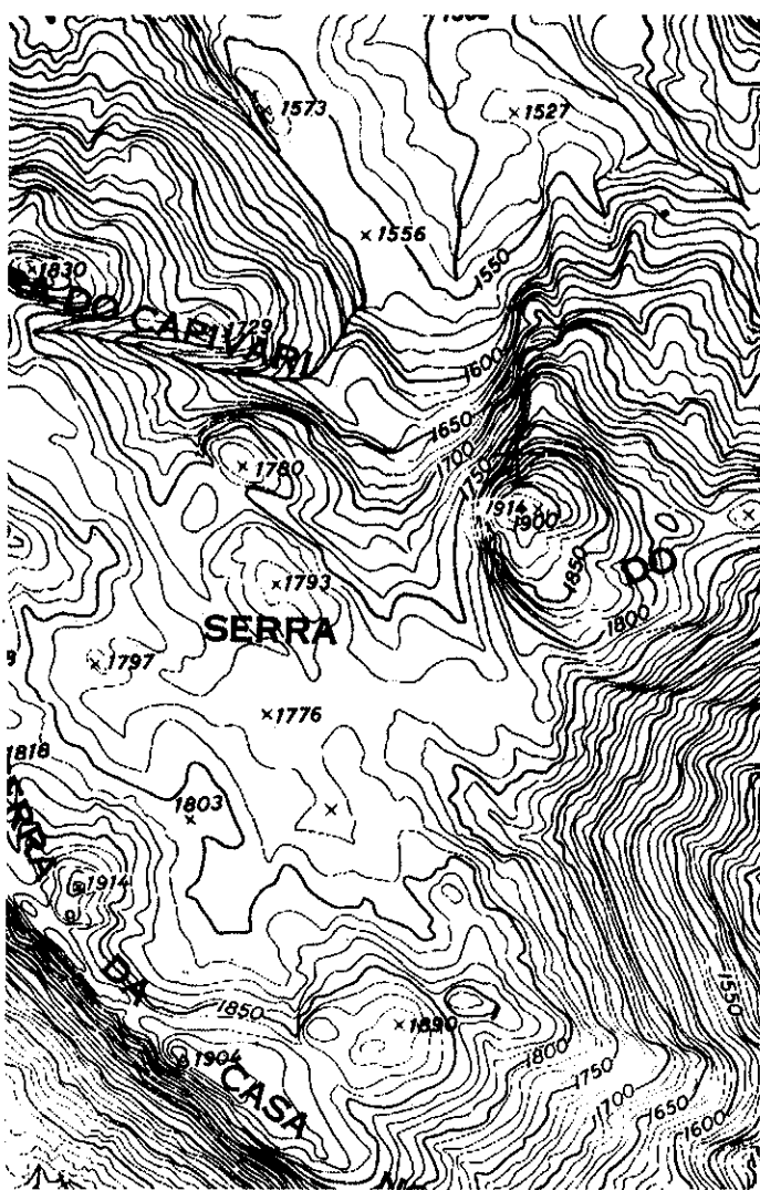
Figura 2 – Padrão de curvas de nível do complexo das superfícies cimeiras na Serra do Coqueiro. Notar o arreísmo total no relevo conservado. Na linha dada pelas cotas 1 573 e 1 556 há uma falha inferida. Notar a SW violenta ruptura de declive, sem falhas, no contacto Quartzitos do Grupo Tamanduá que forma todo o conjunto com os quartzitos do Grupo Maquiné.
