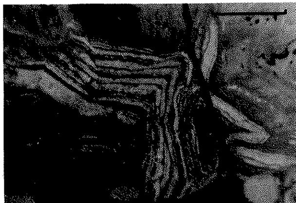
d'hématite se terminant en ogive. Il y a quelques coalescences et des élargissements faisant passer en zig-zag de l'une à l'autre et donnant des zones graphiques vermiculaires. Ces aiguilles se montrent quelquefois à fort grossissement renfermant de petits îlots d'ilménite. Etant d'orientation différente dans de grands cristaux jointifs, elles prouvent que le minéral initial avait une structure grenue.
