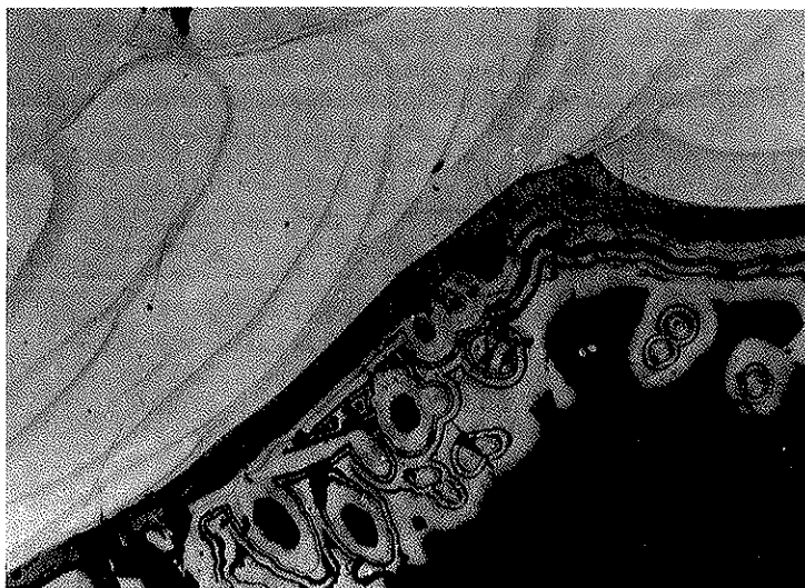
Foto 2 — Fotomicrografia de seção polida. Deposição de material preenchendo cavidades. As camadas coloiformes, cinza-clara, são formadas por criptomelana microcristalina. As concreções, cinza-escuras, são de goethita. (Aumento 60 vezes)
